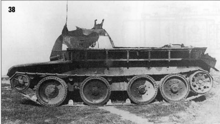
38. Испытания крупнопятнистого деформирующего окрашивания на КБТ-7. НИИБТ полигон, август 1939 г. Tests of large pattern deforming camouflage on KBT-7 tank. NIIBT proving ground, August 1939.
