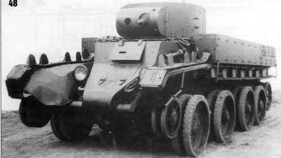
48-50. Химический танк ХБТ-7 на испытаниях. НИИБТ полигон, июль-август 1937 г. Chemical tank HBT-7 on tests, NIIBT proving ground, July-August 1937.
