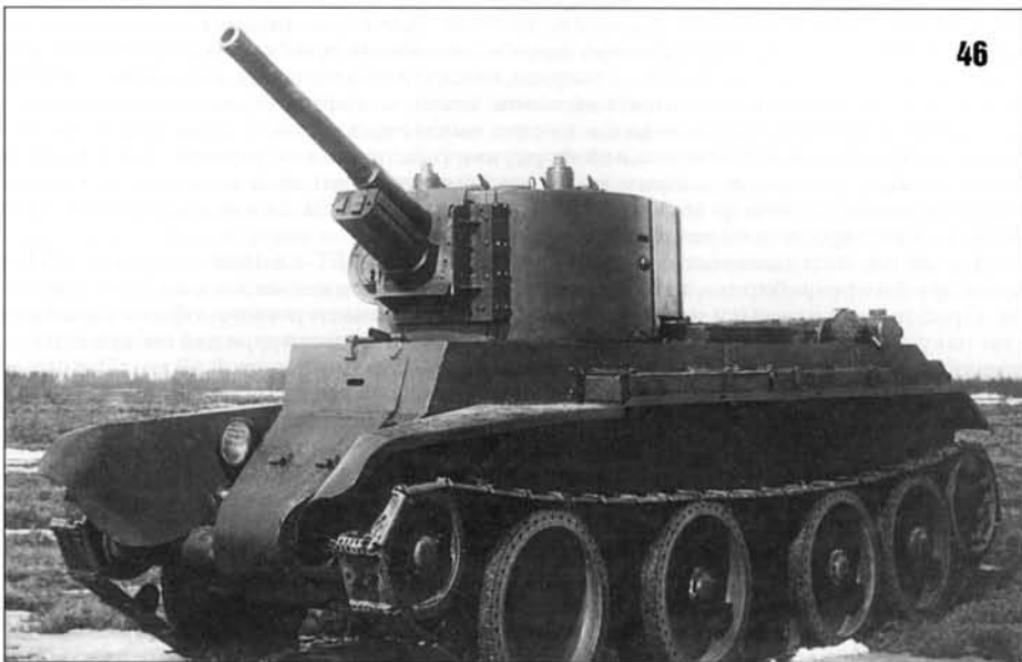
45-47. Танк БТ-7А с 76,2-мм пушкой Ф-32 во время испытаний на АНИОПе. 1939 г. BT-7A tank with F-32 gun on the tests at ANIOP, 1939.
