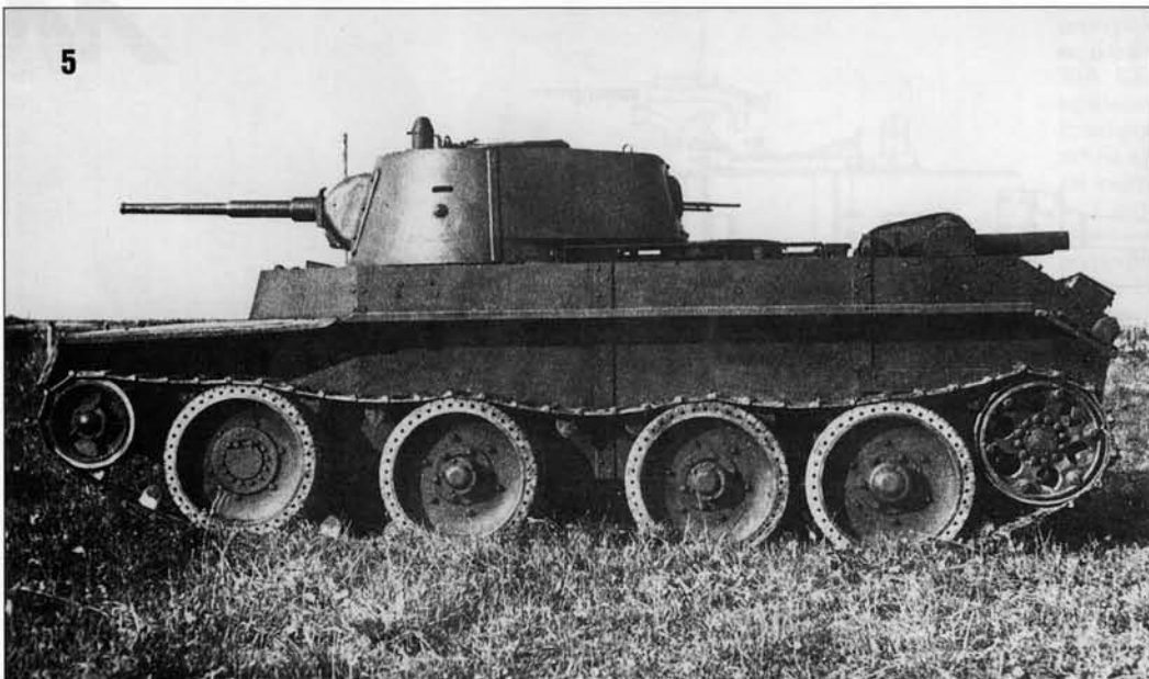
5-7. Танк БТ-7 с конической башней. НИИБТ полигон. 2-я половина 1937 г. BT-7 tank with conical turret. NIIBT proving ground, second half of 1937.
