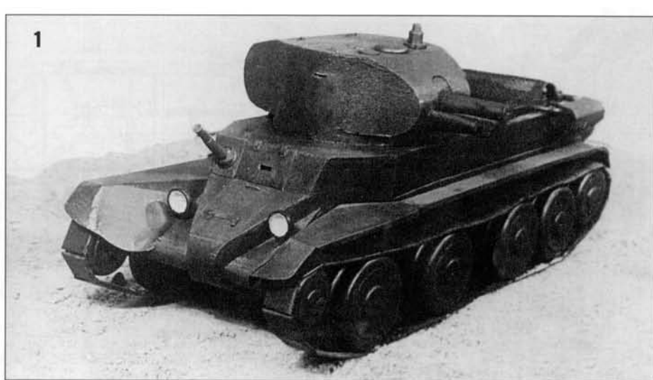
1. Макет опытного образца танка БТ-7. Dummy experimental piece of BT-7.
