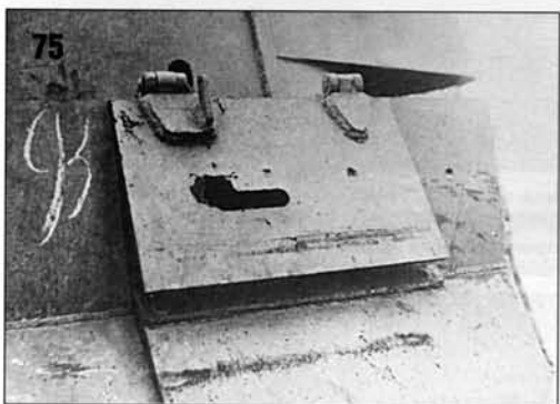
72-75. Наиболее характерные боевые повреждения танков БТ-7, полученные во время боев на р.Халхин-Гол. The most typical battle damages of BT-7 tanks received in action at Khalhin Gol border conflict.
