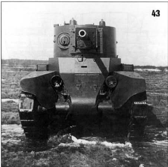
43. Танк БТ-7А с установкой 76,2-мм пушки Ф-32. BT-7A tank with 76,2 mm F-32 gun installed.
