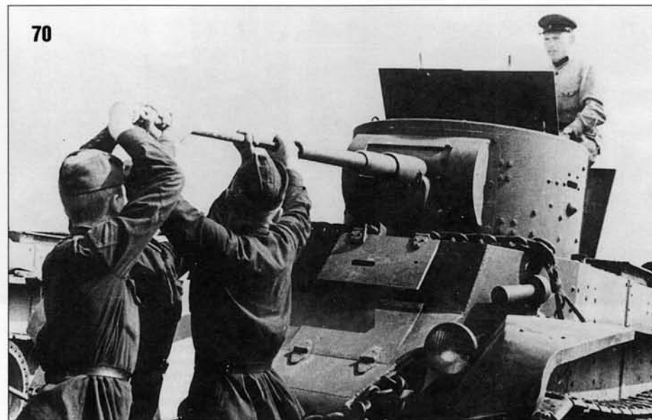
70. Обслуживание экипажем вооружения танка БТ-7 после стрельбы. Лето 1938 г. Maintenance of BT-7 tank armament by its crew after shooting practice. Summer 1938.
